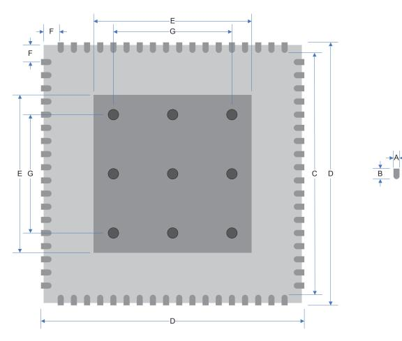
Figure 4 72 Lead QFN Land Pattern (QFN package QH072AF2A)
